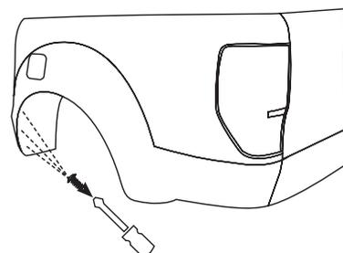
3. Drücken Sie nun die Kotflügelverkleidung vom Kotflügel und schieben Sie die Klemmen von innen über den Kotflügelrand, so dass die Bohrungen bündig sind. Achten Sie darauf, dass die Klemmen den Korrosionsschutz nicht beschädigen.
