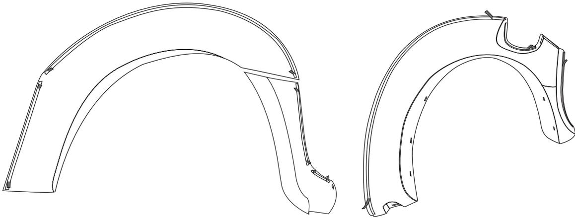
5. Positionieren Sie die Kotflügel korrekt und drücken Sie die Teile leicht an. Befestigen Sie nun den Kotflügel indem Sie die beiliegenden Schrauben und Unterlegscheiben in den Löchern einsetzen und fest anschrauben. Gegebenenfalls Schmutzfänger auf der Kotflügelverbreiterung aufsetzen und mit anschrauben.
